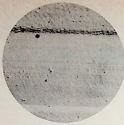
Afb. 14b. Plaatgroef 12 000 × vergroot. De elliptische naald is 100 maal door de groef gegaan. De plaatstructuur is veranderd.
